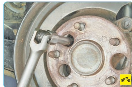
8. Через технологические отверстия выверните четыре болта крепления ступицы к рычагу задней подвески и снимите ступицу заднего колеса.
