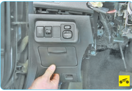
7. Снимите облицовку блока корректора света и омывателя фар и блока управления приводом наружных зеркал.
