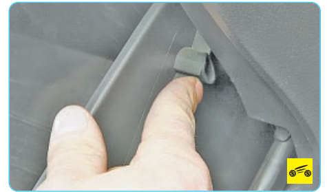
3. С боков ящика отожмите ограничители и опустите вещевой ящик вниз до конца.
