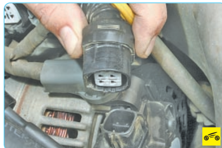
7. ...и отсоедините колодку от генератора.
