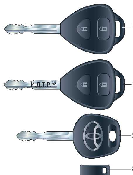
Рис. 1.7. Ключи автомобиля без системы Push Start: 1 – основной ключ; 2 – запасной ключ; 3 – бирка
