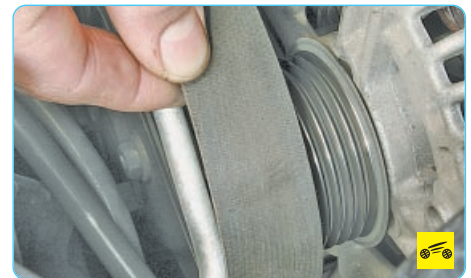
12. Ослабьте натяжение ремня привода вспомогательных агрегатов (см. «Проверка, регулировка и замена ремня привода вспомогательных агрегатов», с. 68) и снимите ремень со шкива генератора.
