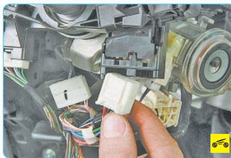
13. Аналогично отсоедините вторую колодку жгута проводов от переключателя стеклоочистителя и стеклоомывателя.
