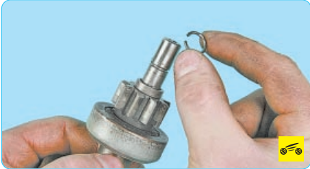
19. ...снимите стопорное кольцо.
