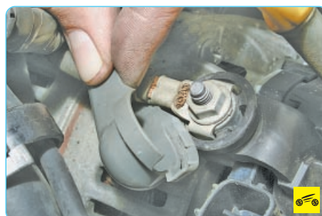
9. ...и снимите защитный колпачок вывода генератора.
