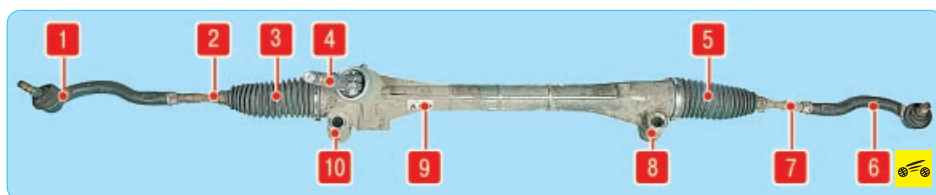
Рис. 8.2. Рулевой механизм: 1, 6 – наконечники рулевых тяг; 2, 7 – рулевые тяги; 3, 5 – защитные чехлы; 4 – вал рулевого управления; 8, 10 – кронштейны крепления рулевого механизма 9 – картер рулевого механизма
