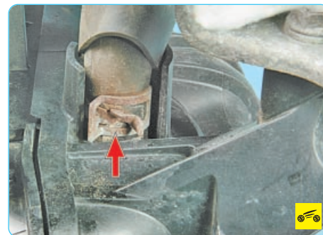
6. ...и крепление на впускном коллекторе.
