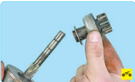
21. ...и шестерню привода с вала планетарного механизма. Зубья шестерни привода не должны иметь значительного износа. Шестерня должна легко проворачиваться относительно ступицы муфты в направлении вращения ротора и не должна проворачиваться в противоположном направлении. Если зубья шестерни изношены или повреждены либо шестерня проворачивается в обоих направлениях, замените привод.
