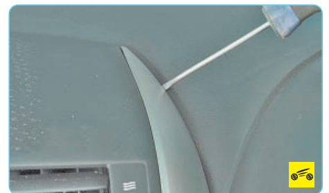
6. Подденьте отверткой и снимите верхнюю правую боковую накладку облицовки тоннеля пола.
