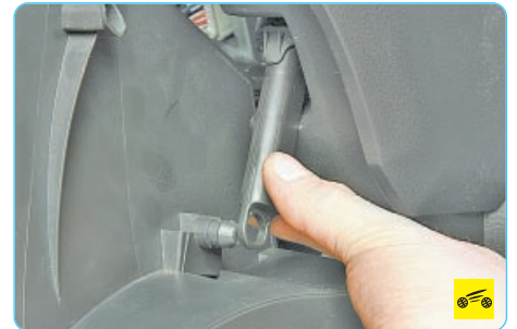
4. С правой стороны ящика сожмите лепестки фиксатора и отсоедините тягу нижнего вещевого ящика.
