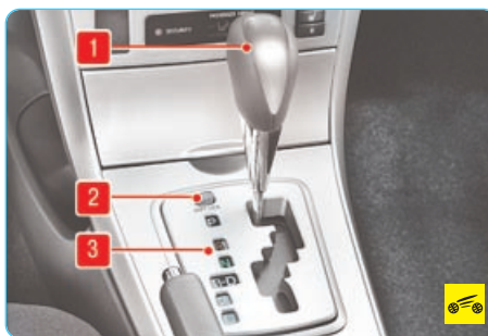
Рис. 1.13. Рычаг селектора управления автоматической коробкой передач: 1 – рукоятка рычага; 2 – кнопка блокировки включения передачи; 3 – шкала автоматического режима управления
