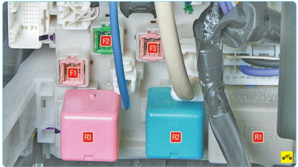
Рис. 10.1. Номера реле и плавких вставок в монтажном блоке, расположенном в салоне
