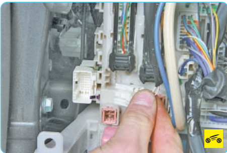
9. ... и отсоедините колодку жгута проводов проводки крыши.
