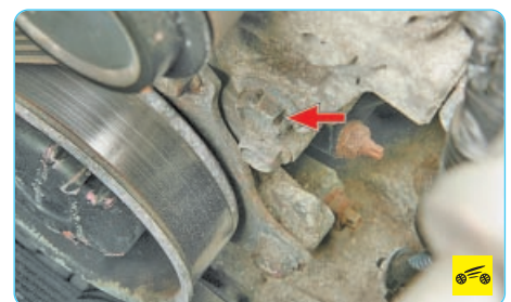
14. ...и нижний болты крепления генератора (показан стрелкой) и снимите генератор с автомобиля.
