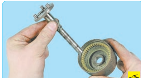
24. ...а также упорное кольцо с вала планетарного механизма.
