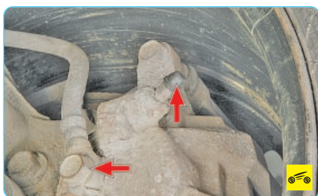
9. Осмотрите соединения шлангов с рабочими цилиндрами и клапаны для выпуска воздуха тормозных механизмов передних...
