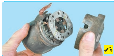
27. ...и разъедините корпус статора и крышку со стороны коллектора.
