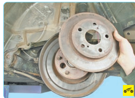
7. Снимите тормозной диск (см. «Замена тормозного диска тормозного механизма заднего колеса», с. 155).
