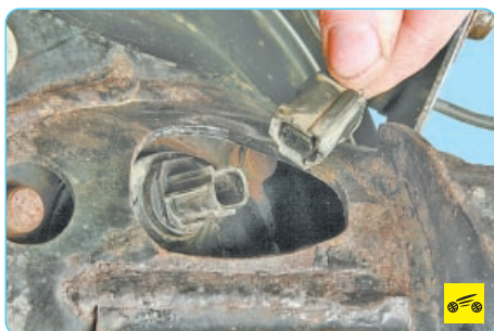
5. Отсоедините колодку жгута проводов датчика частоты вращения колеса (см. «Замена датчиков частоты вращения колес», с. 250).
