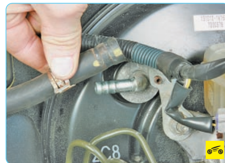
8. ...и отсоедините от него вакуумный шланг.
