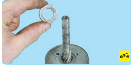
24. ...а также упорное кольцо с вала планетарного механизма.
