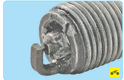
7. Изолятор свечи растрескавшийся или со сколами.
