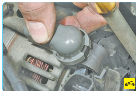
8. Отожмите фиксаторы крепления защитного колпачка...
