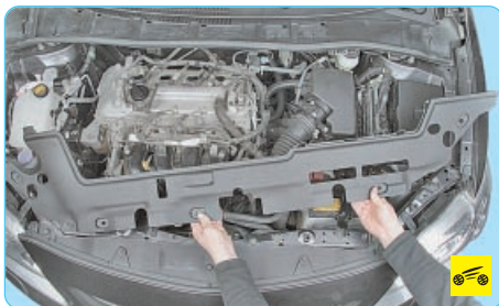
4. Снимите переднюю облицовку моторного отсека (см. «Снятие и установка облицовок моторного отсека», с. 62).
