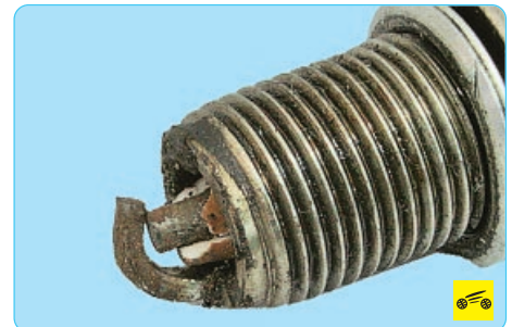
8. Механические повреждения электродов и изолятора свечи.
