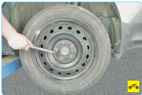
3. На стоящем на земле автомобиле ослабьте затяжку гаек крепления заднего колеса со стороны предполагаемой замены.
