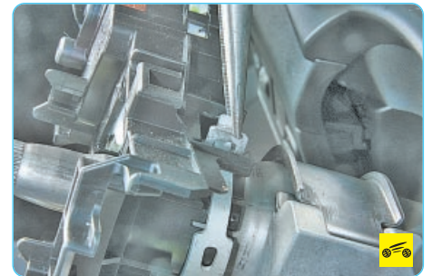
17. Сожмите пассатижами отогнутые уши фиксатора и снимите переключатель.
