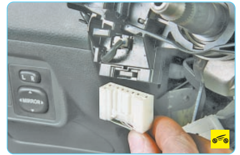
16. Отсоедините колодку жгута проводов от переключателя света фар.
