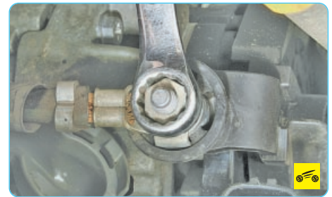
10. Отверните гайку крепления наконечника силового провода...
