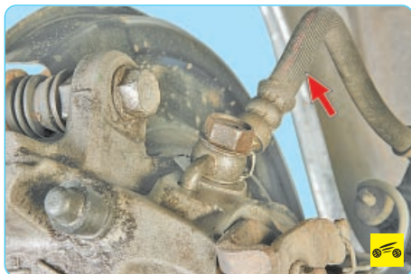
7. ...и задние тормозные шланги. На них не должно быть трещин, надрывов и потертостей.
