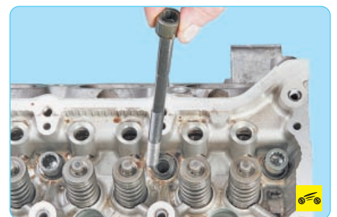
15. ...окончательно выверните болты крепления головки, выньте их...
