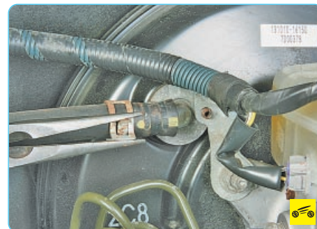
7. Для проверки работы обратного клапана сожмите хомут пассатижами...
