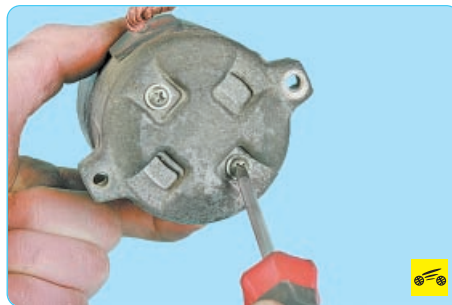
26. Выверните два винта...
